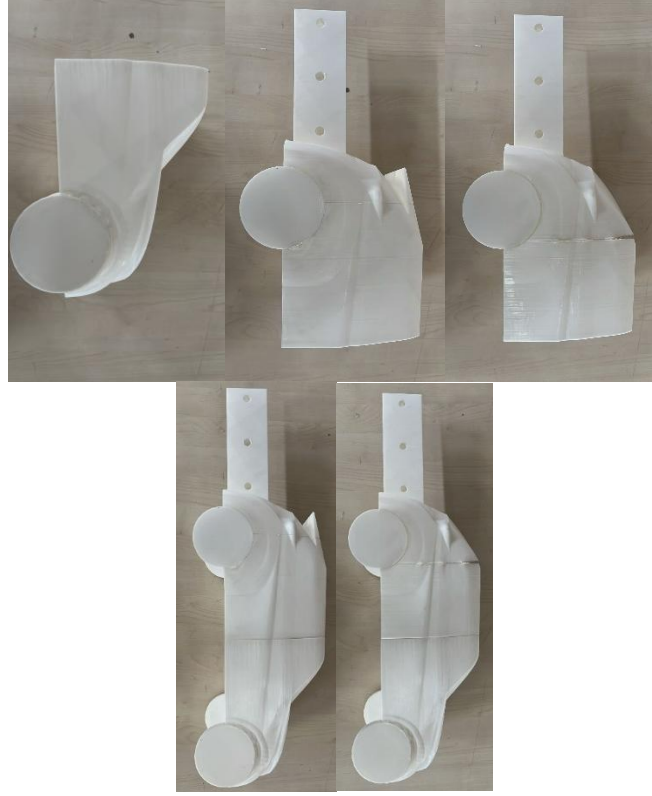
Şekil 13: Rüzgâr tüneli deneyi için 3D yazıcı cihazı ile PLA+ malzemesinden üretilen model kesitleri(üst) ve montajlanmış halleri(alt)
