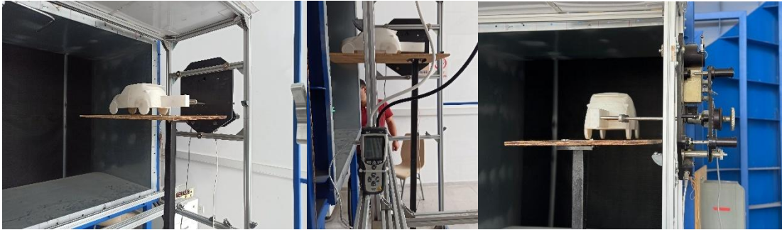
Şekil 14: Rüzgâr tüneli deneyi için hazırlanan deney düzeneği
