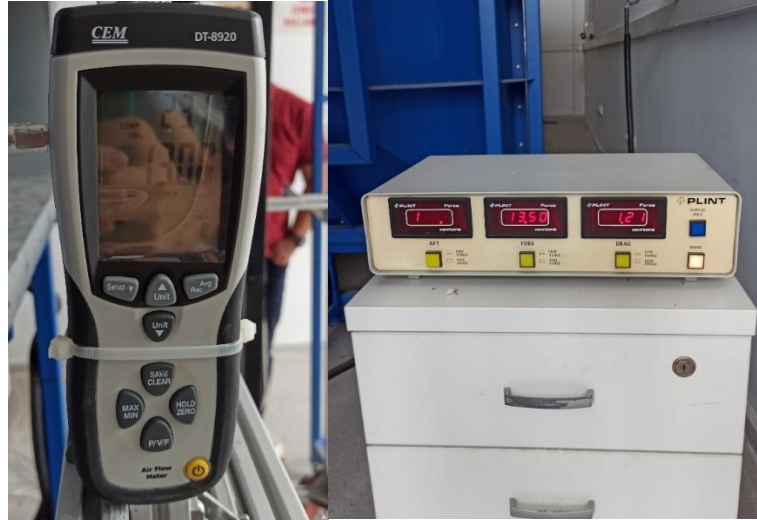
Şekil 15: Deney süresince rüzgâr tüneli çıkışındaki havanın hızı ve x y z eksenlerinde oluşan kuvvetlerin ölçümünün alındığı elektronik cihazlar
